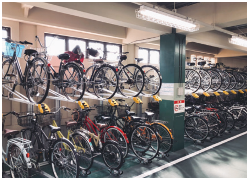
トップガイド(自転車が直立し、左右操作が容易)と自動解除式フットブレーキを装備したスライドラックもARS (Auto Return Safety) 垂直2段式ラックの特長で、下段ラックが動かしやすい
