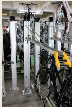
ガススプリングによる穏やかな操作性が特徴のOSS製垂直昇降2段式ラック
