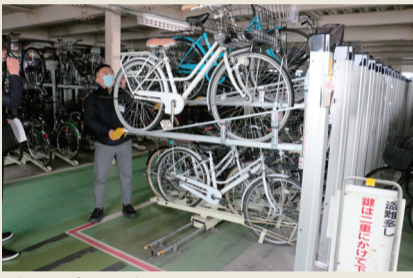
ガススプリングによる穏やかな操作性が特徴のOSS製垂直昇降2段式ラック
